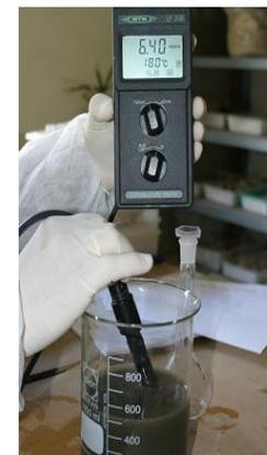
Vista del conductímetro portátil
