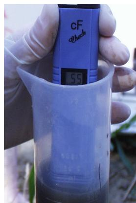
Vista del conductímetro de bolsillo
